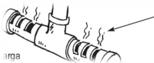
tubería con ranuras para distribuir a la entrada y recoger a la salida uniformemente las aguas
